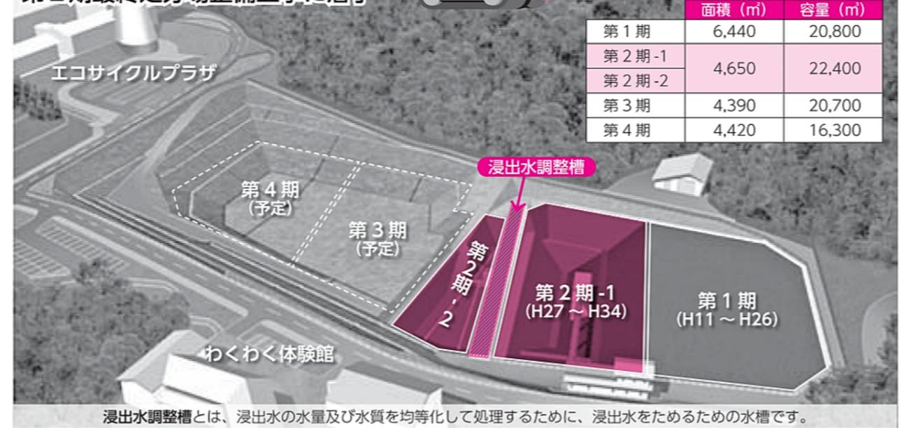
ささゆりクリーンパーク建設当初の計画では、溶融スラグ埋立処分場第1期の埋立容量が6年間で満杯になる予定でしたが、土木資材などとして多くのスラグが再利用され、10年間も延命することができました。しかし、平成26年度末には第1期埋立容量が満杯になると見込まれることから、新たに埋立容量の確保が必要となり、平成26年度に第2期目の整備工事をを行い、浸出水調整槽を境に2期-1及び2期-2とするものです。
