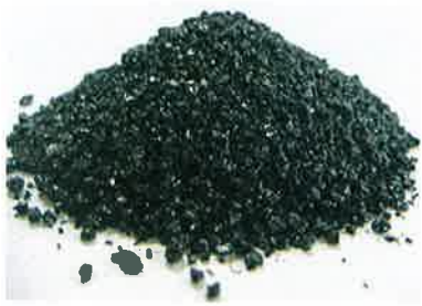
③焼却灰を灰溶融炉で溶かして出来るのが、溶融スラグです
