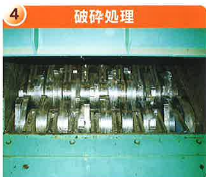
4 破砕処理 破砕機 2種類の破砕機を使って、細くします。
