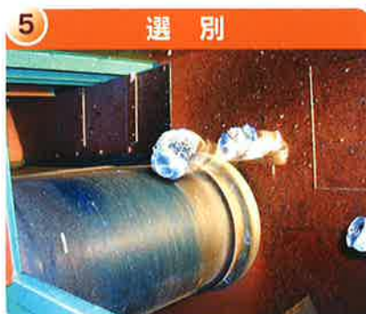
5 選別 選別機 磁選機とアルミ選別機により、鉄とアルミを分けます。
