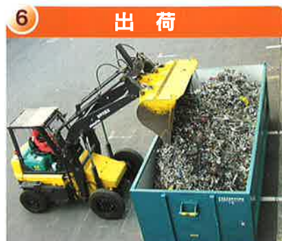
6 出荷 破砕鉄 選別された鉄・アルミを、リサイクル工場へ出荷します。
