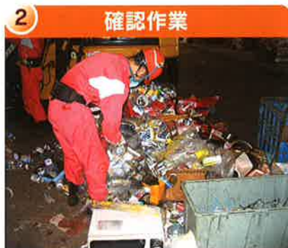
2 確認作業 プラットホームで確認 作業員が一つ一つ袋を破り、安全確認してからごみピットへ投入します。
