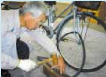
接着周囲をこすり接着剤を適量に付け放置し乾き始めたらパッチを貼り付け、ハンマーでやさしく叩きます。
