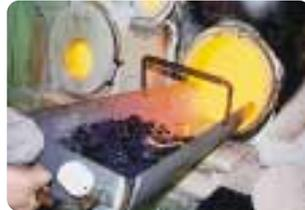
カレットにし、吹きガラスの原料に混ぜる。カレットとは、ガラスを砕いたもの。ガラスの粉末原料に混ぜると、溶解を促進する役割を果たす。
