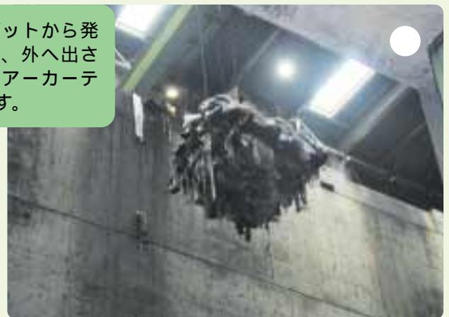
収集車が投入した可燃ごみは、クレーンで焼却炉の入口(ホッパー)まで運んでいきます。家庭で出されたごみは、そのまま焼却炉へ運ばれますよ!
